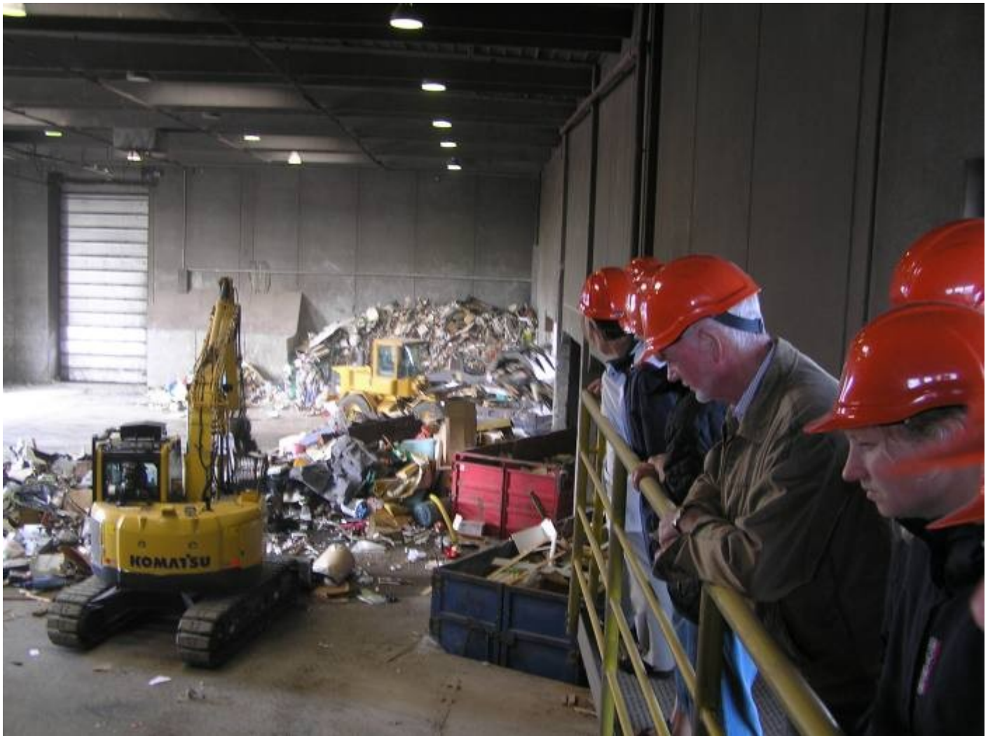
Som det ses ryger meget andet end dåser og plastdunke i containerens andet rum. Tingene grovsorteres først med hjælp af rå maskinkraft.
