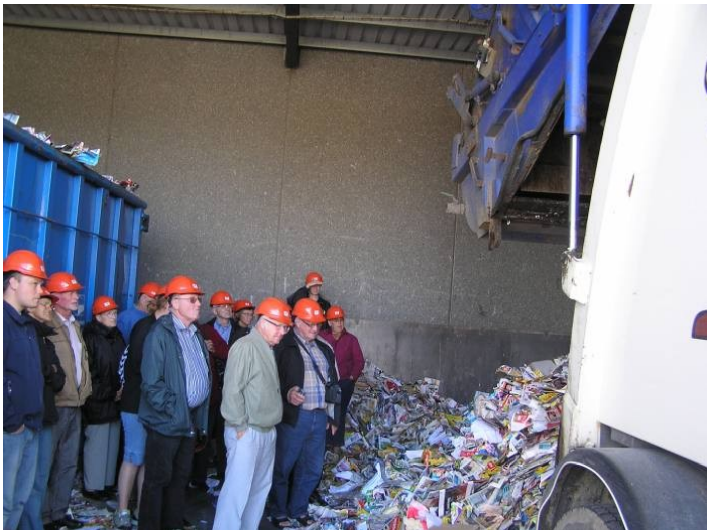
Genbrugscontainerens papirdel tømmes af i en lukket hal. De fyldte papircontainere afhentes senere af det firma, som genanvender papiret.
