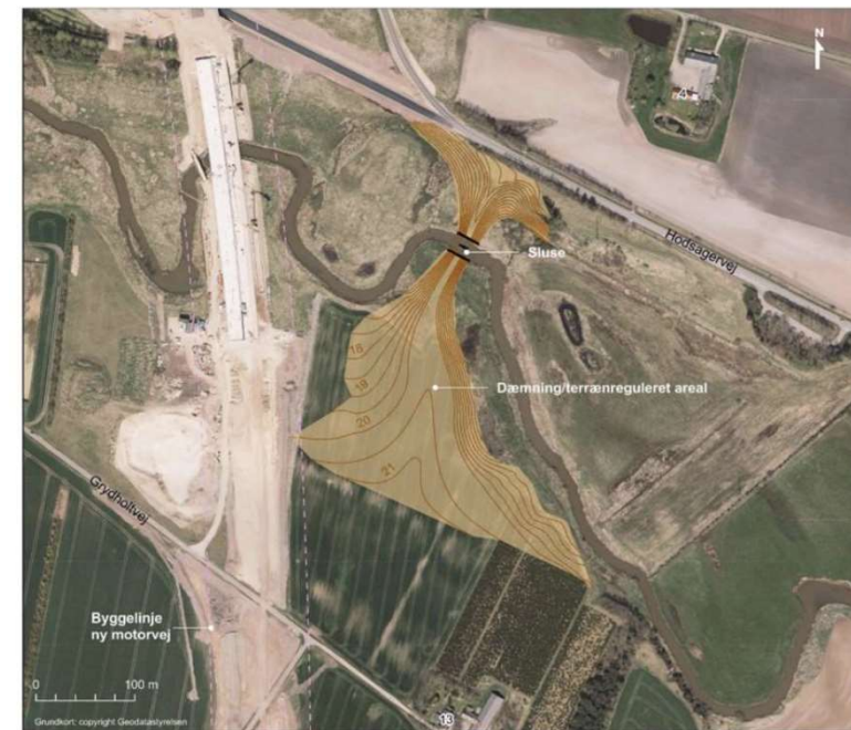
Figur 3-6 Luftfoto fra 2017 med skitsering af dæmning med sluseporte i Storådal – der forventes anlagt en midlertidig arbejds- og adgangsvej fra syd. Dennes nærmere placering indarbejdes i det kommende detailprojekt.
